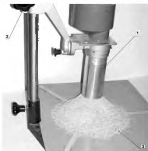
Рис. 3 – Прилад для визначення кутів природного укосу сипучих матеріалів: 1 – порожнистий циліндр; 2 – механізм піднімання циліндра; 3 – площина з розміткою
