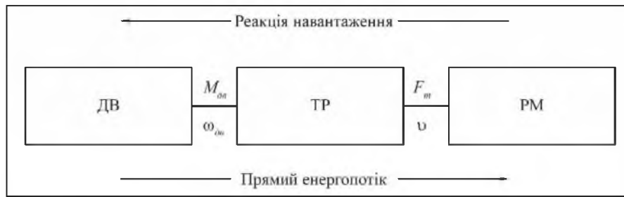
Рис. 1 – Машино-тракторний агрегат як енергетична система:
