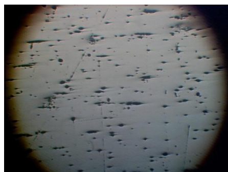
Рис. 6 – Включения в основном металле
