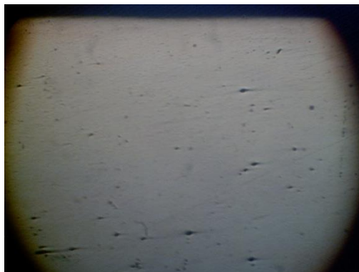
Рис. 8 – Зона термического влияния с минимальным количеством включений
