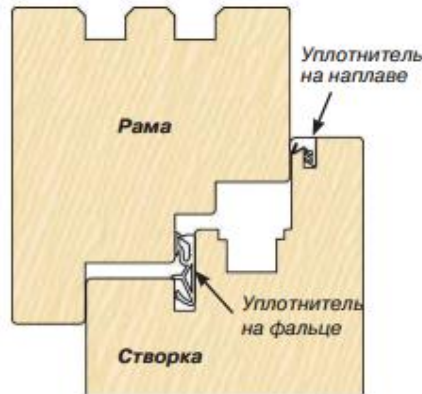
Рисунок 3 – Установка уплотнителя на наплав.
