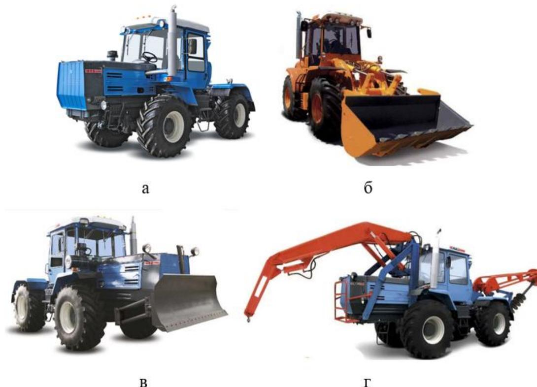
Рис. 1. Специальные машины на базе колесного трактора ХТЗ-150К-09-25.
