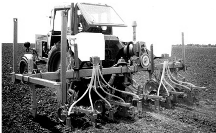
Рис. 3. - Посевная машина с высевающей системой на основе элементов пневмоструйной техники в виде приспособления к пропашному культиватору КРН-4,2
