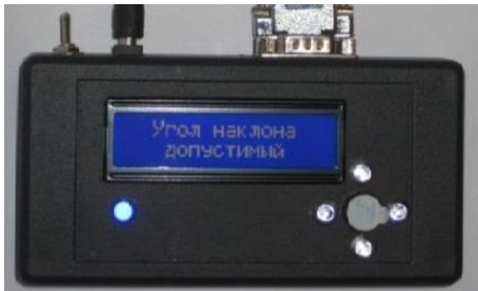
Рис. 3 - Система контроля предельных углов наклона мобильной машины
