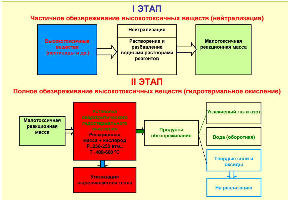
Рисунок 5 – Концепция обезвреживания высокотоксичных веществ
