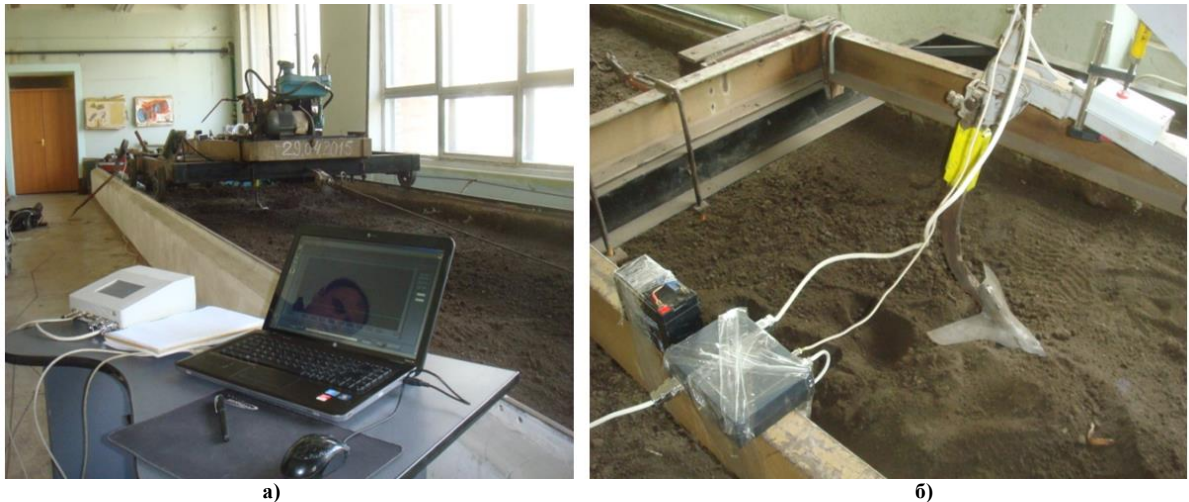
Рис.3. Засоби фіксації та вимірювань тягового опору лап культиватора в ґрунтовому каналі: а – вимірювальний комплекс; б – експериментальна лапа з тензодатчиками на стовбі
