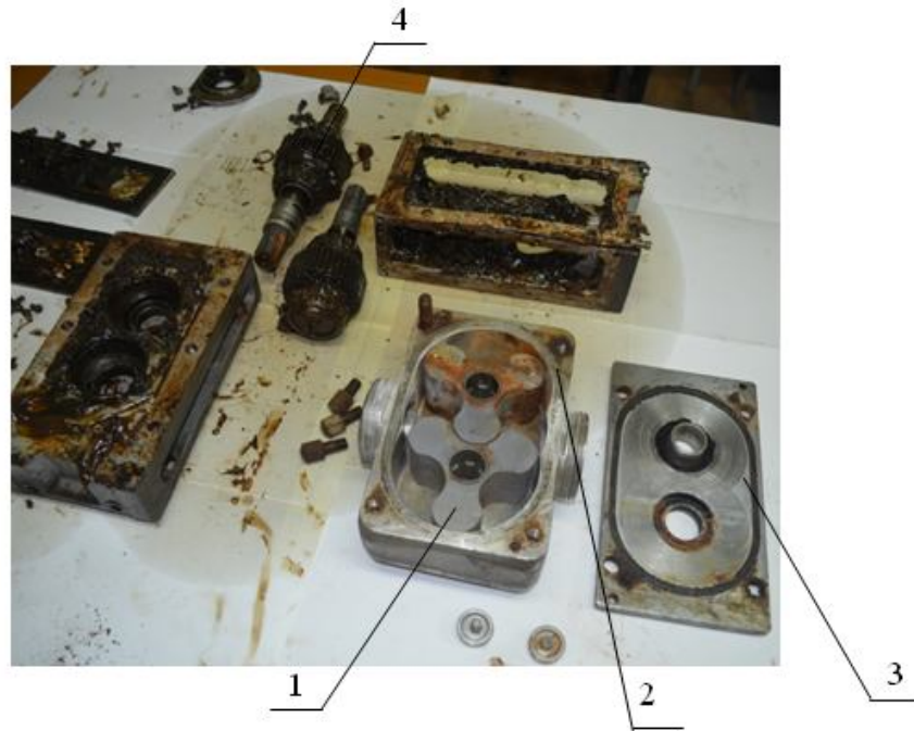
Рис. 1 – Робочі деталі насоса роторного НР-10, знятого з експлуатації 1 - камера з роторами, 2 - корпус, 3 - проміжна кришка 4 - вали
