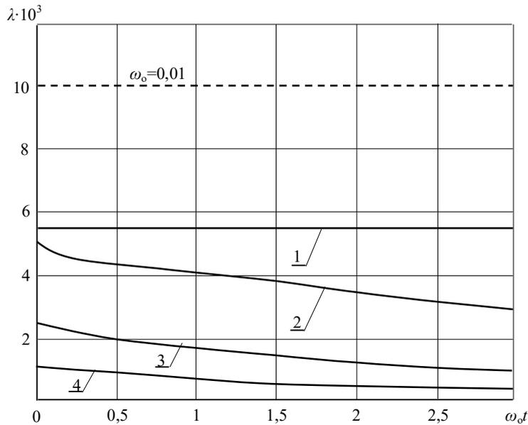
Рис. 2. Графики функции интенсивности внезапных отказов при стационарном пуассоновском потоке нагружений
