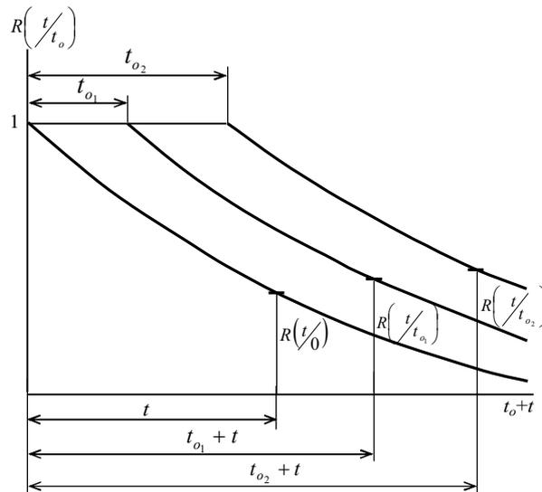
Рис. 3. Вид графиков изменения условной вероятности безотказной работы с увеличением отработанного периода
