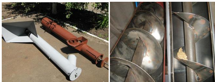
Рис. 2 – Серійний (CVC-25) та експериментальний шнековий живильник
