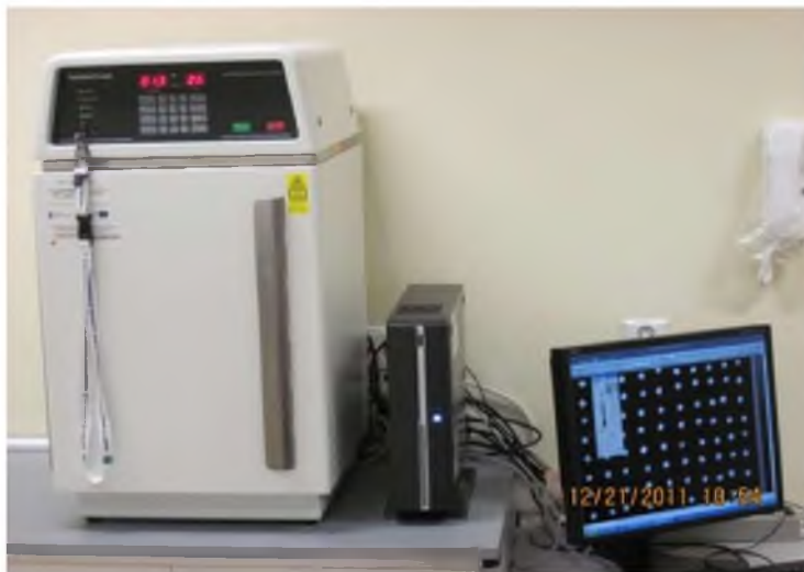
Рис. 4 – Прилад Faxitron MX-20 для проведення рентгеноскопії насіння
