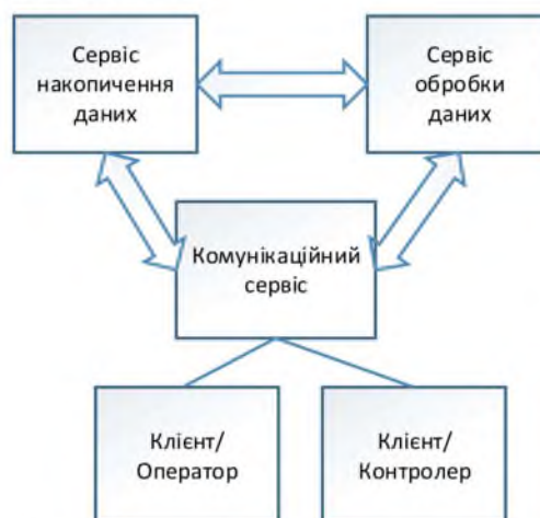
Рис. 5 – Структура серверної частини системи
