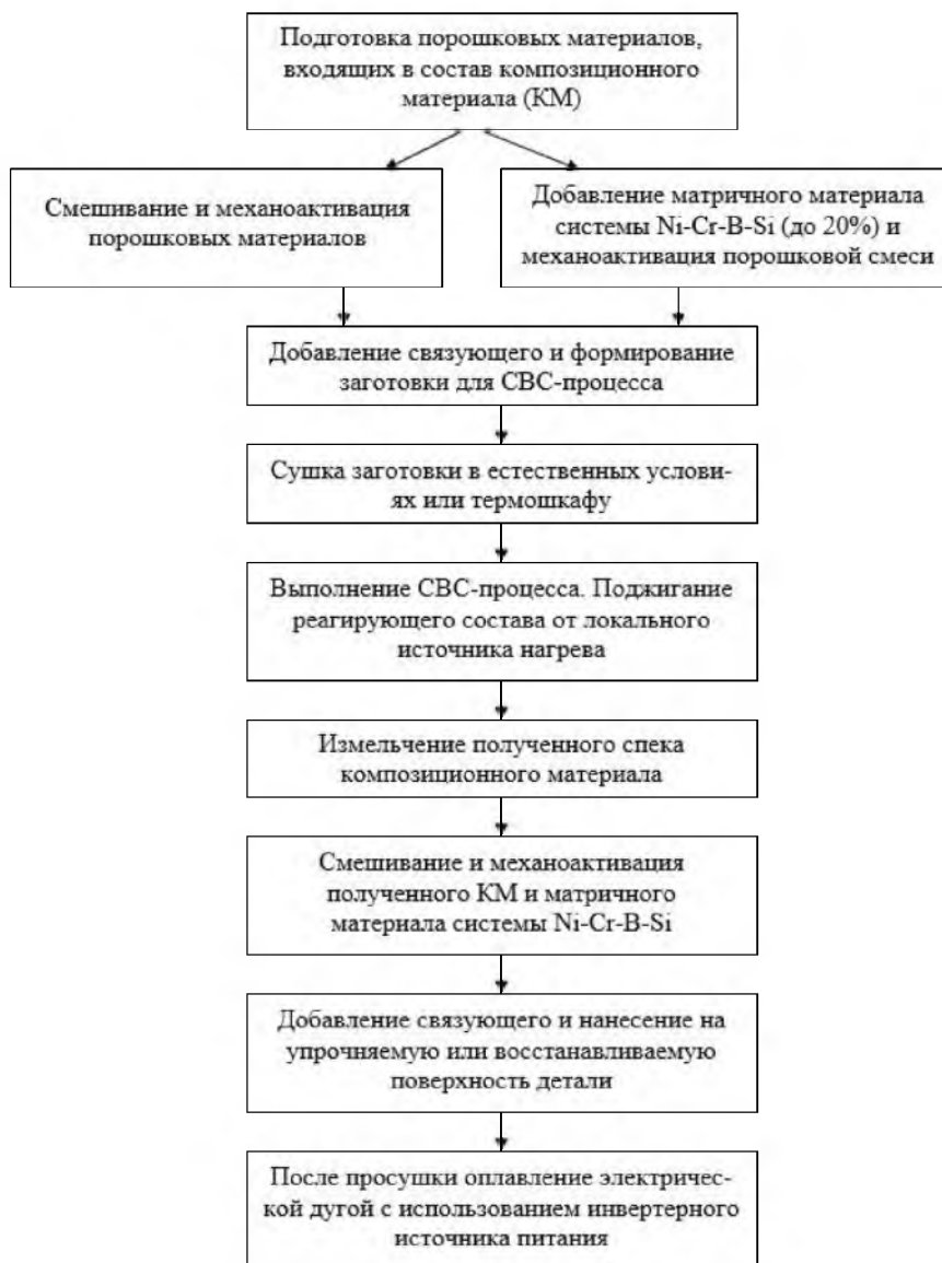
Рис. 1 – Алгоритм разработки технологии наплавки защитных покрытий, модифицированных износостойкими композиционными материалами, полученными с применением CVC-процесса
