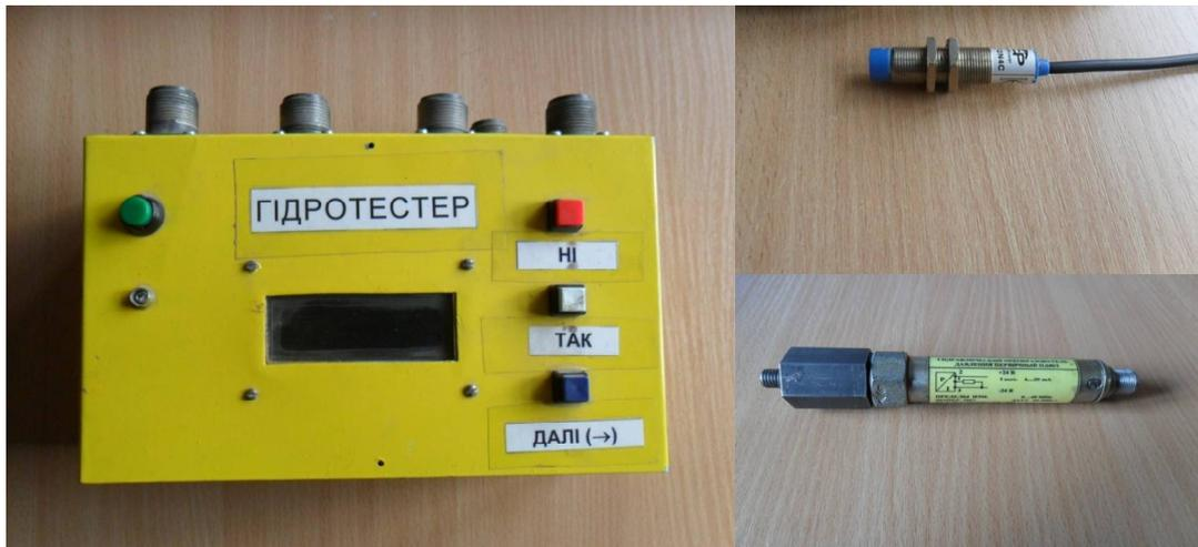
Рис.1. Внешний вид электронного блока измерительного комплекса, индукционного датчика оборотов и датчика давления
