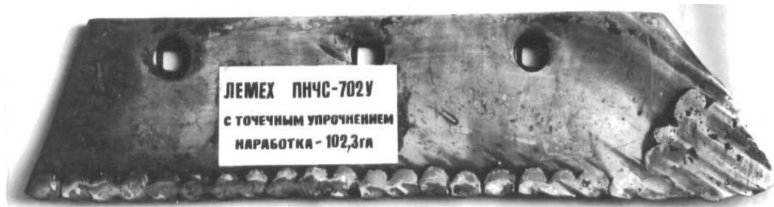
Рис. 4. Леміш з точковим зміцненням після наробітку 102,3 га.
