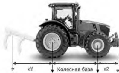
Рис.1 – Перерозподіл експлуатаційної ваги трактора з навісним зняряддям
