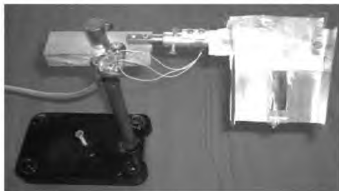
Рис. 2 – Загальний вигляд вимірювача маси потоку дисперсних матеріалів
