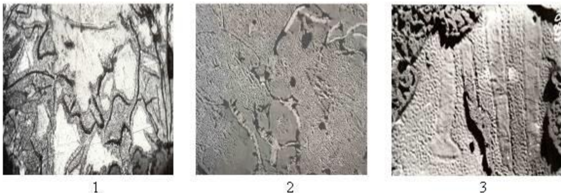
Рис. 1. Оптическая микроструктура серого феррито-перлитного чугуна: литое состояние – фото 1, \times 500 ; после пластической деформации – 2, \times 200 ; 3, \times 1000 .
