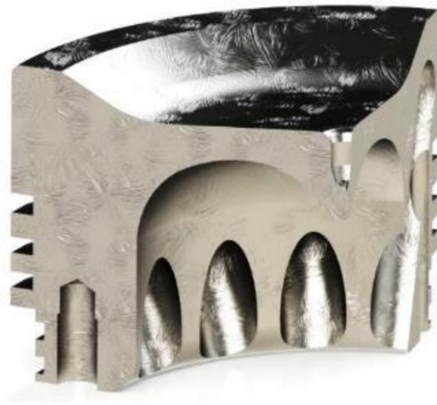
Рис.3 – Твердотільна модель модернізованого днища поршня
