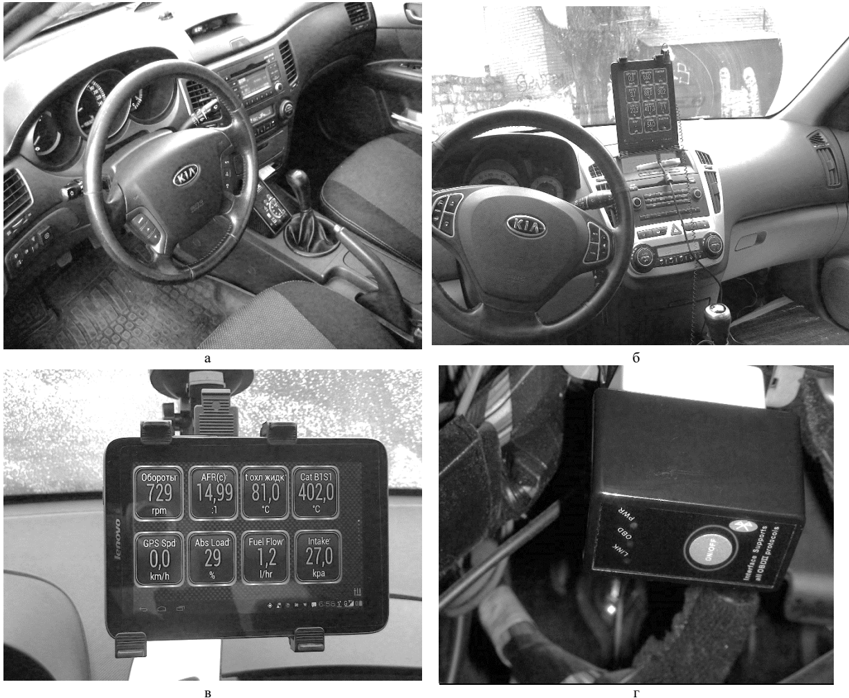
Рис. 2 – Загальний вигляд елементів бортової системи моніторингу параметрів технічного стану (СМПТС) і положення ТЗ для дослідження роботи ТЗ, обладнаного системою впорскування газового палива і системою теплової підготовки з ФТА, в умовах експлуатації засобами ITS: розташованому в автомобілі KIA Magentis 2.0 5MCPH (а); автомобілі Kia Cee'd 2.0 5MT2 (б); бортовий монітор СМПТС (в) і бортовий діагностичний сканер - адаптер Scanmaster ELM327 (г)
