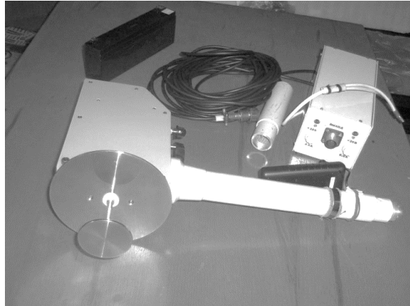
Рис. 1 – Прилад ГА-1 для виявлення ГПЗ на місцевості
