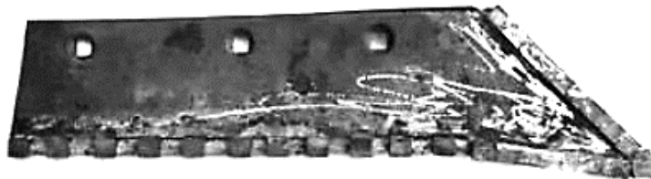
Рис. 6 – Загальний вигляд зміцненого леміша металокерамічними пластинами [12]
