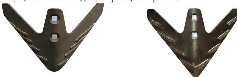
Рис. 5 – Загальний вигляд зміцненої лапи локальним методом [11]
