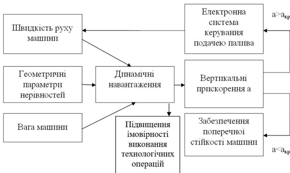
Рис. 3 – Блок-схема захисту шарнірно-зчленованих колісних машин від перекидання використанням бортової електронної системи
