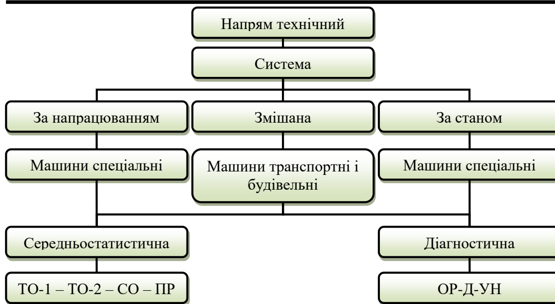
Рис.2. Схема організації ТО і Р транспортних машин
