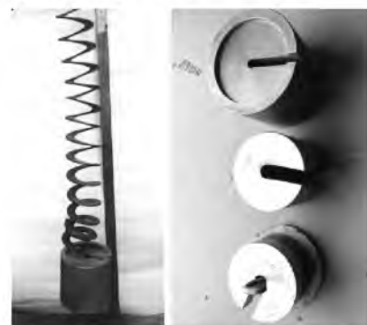
Рис. 6 - Загальний вигляд навантаженої спіралі і тягарців, що використовувались при виконання досліджень
