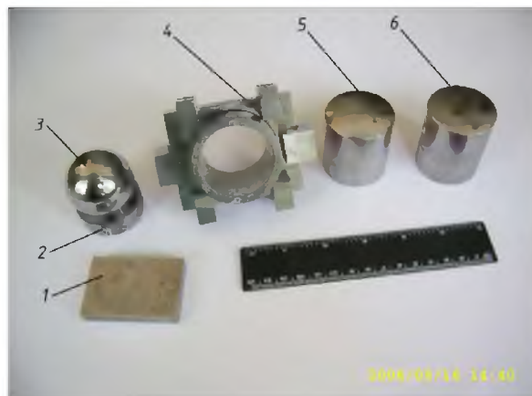
Рис. 5 – Внешний вид устройства для измерения силы удара упругоконтактным методом: 1 – пластина; 2, 5, 6 – пуансоны; 3 – шар; 4 – корпус
